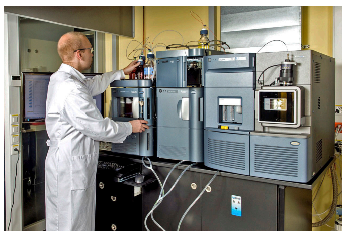
Acquity UPLC Trennungssystem gekoppelt mit einem Xevo TQ-S (Waters) Massenspektrometer am Inselspital Bern: Das UPLC trennt die Metaboliten, das Massenspektrometer ionisiert dann die Moleküle für die Analysen.
