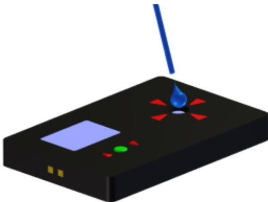
Labcard hat viele Vorteile gegenüber den Konkurrenzprodukten. Es handelt sich um eine tragbare und voll autonome Messkarte, mit integrierter Datenspeicherung und Übermittlung.
