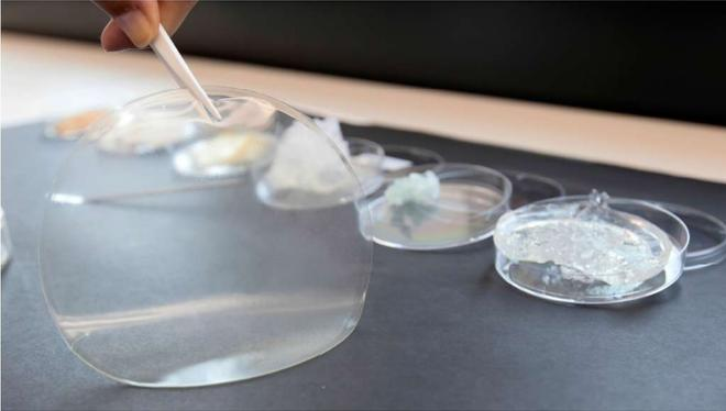
Polyhydroxyalkanoate sind eine grosse Klasse von Biopolyestern, deren physikalische Eigenschaften sich durch die Wahl des Produktionsstammes und der zur Verfügung gestellten Substrate einstellen lässt. (Bild photo-genic.ch)
