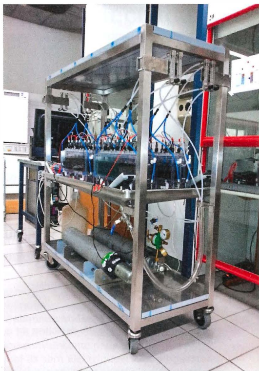
Figure 4 : Pile à combustible microbienne pilote pour examiner les conditions de mise à l'échelle. L'objectif est de générer de l'électricité et d'économiser l'énergie en épurant de l'eau usée. (Photo : Fabian Fischer).
