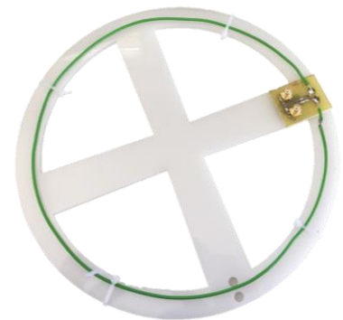
L'antenne en forme de boucle utilisée pour détecter avec plus de précision la position d'une SensorBall
