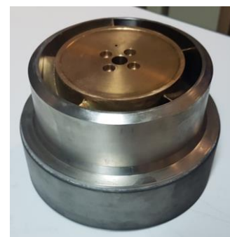
Rotor des nouvelles génératrices avant montage
