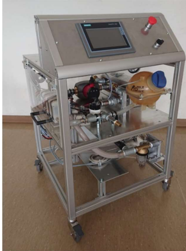
Figure 1 : Assemblage final du chariot (Taille 600x600x900mm)
