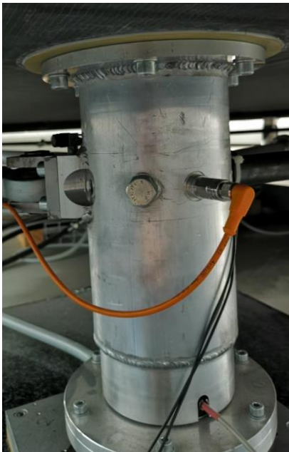
Montage d'un accéléromètre sur un des pieds du simulateur
